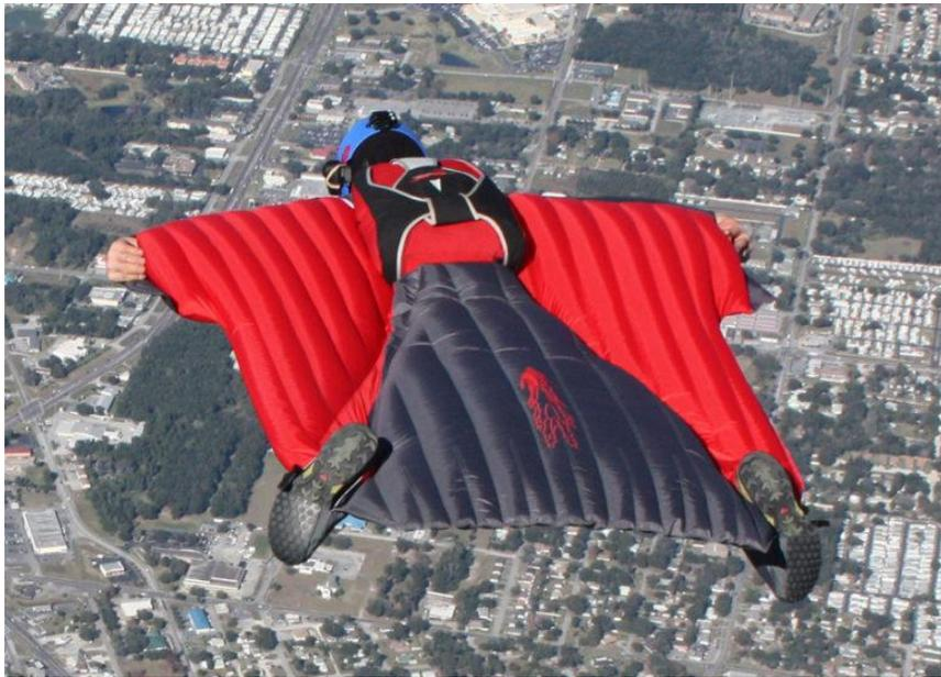
**Notez la bonne position de ce pilote, quasiment aucune déformation, pas de dièdre et ni de modification de flèche.**
