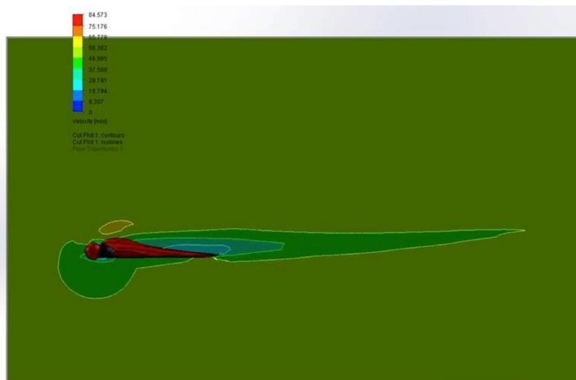
Figure 4. Coupe transversale des vitesses sur un prototype Squirrel. Le centre de poussée est derrière la tête du pilote.
